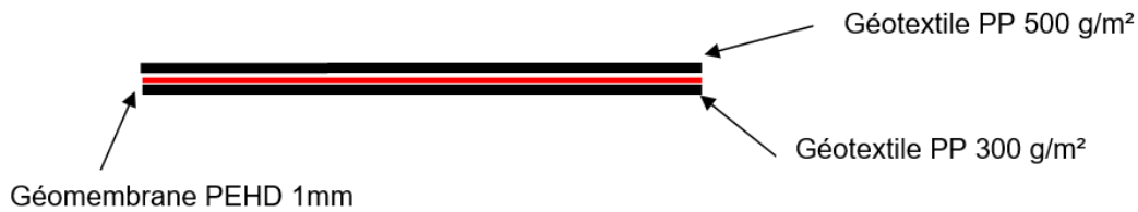
Figure 2. Assemblage des couches constituant le géocomposite
